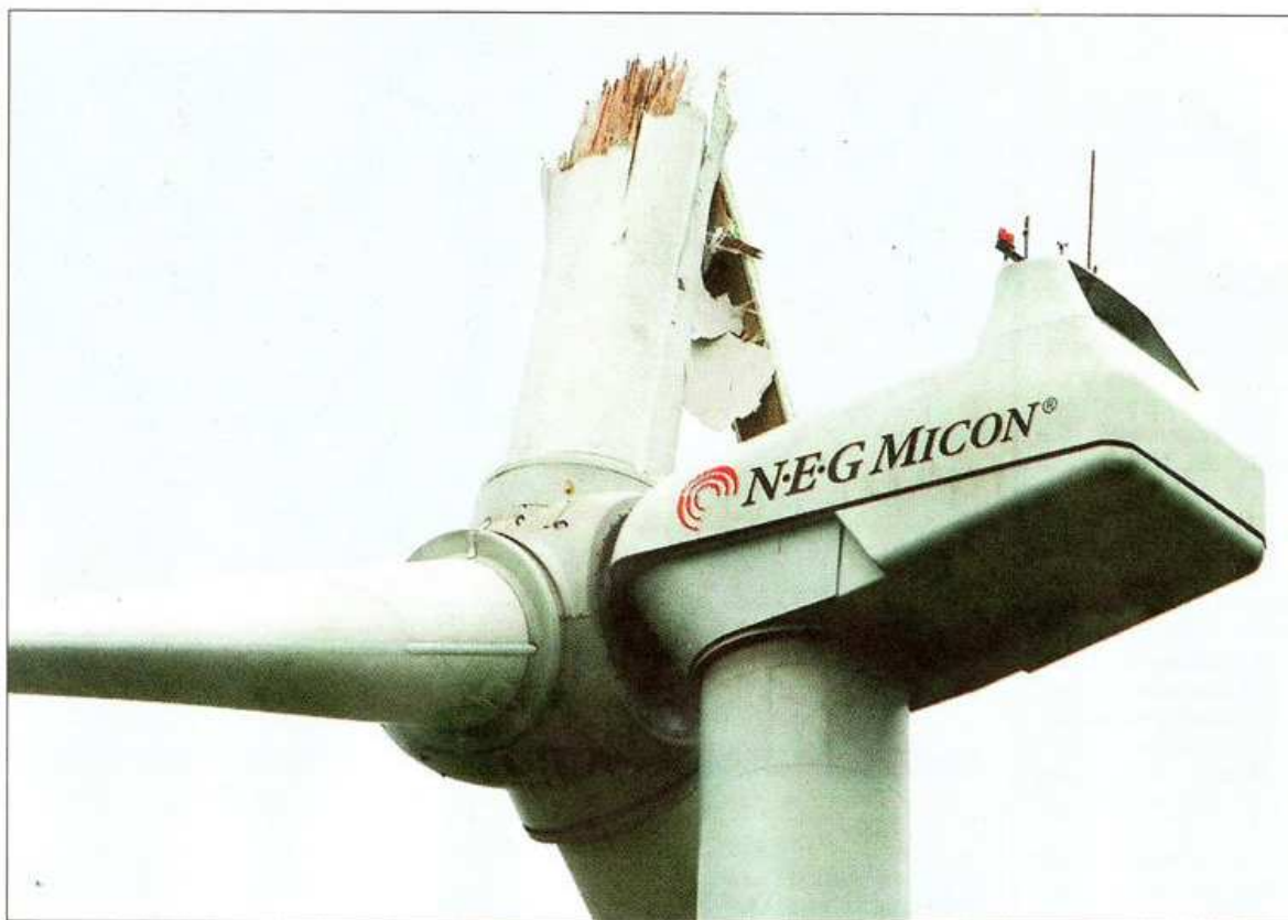
Ein etwa zwei bis drei Meter großer Stumpf blieb vom Rotorflügel noch an der Nabe hängen.
